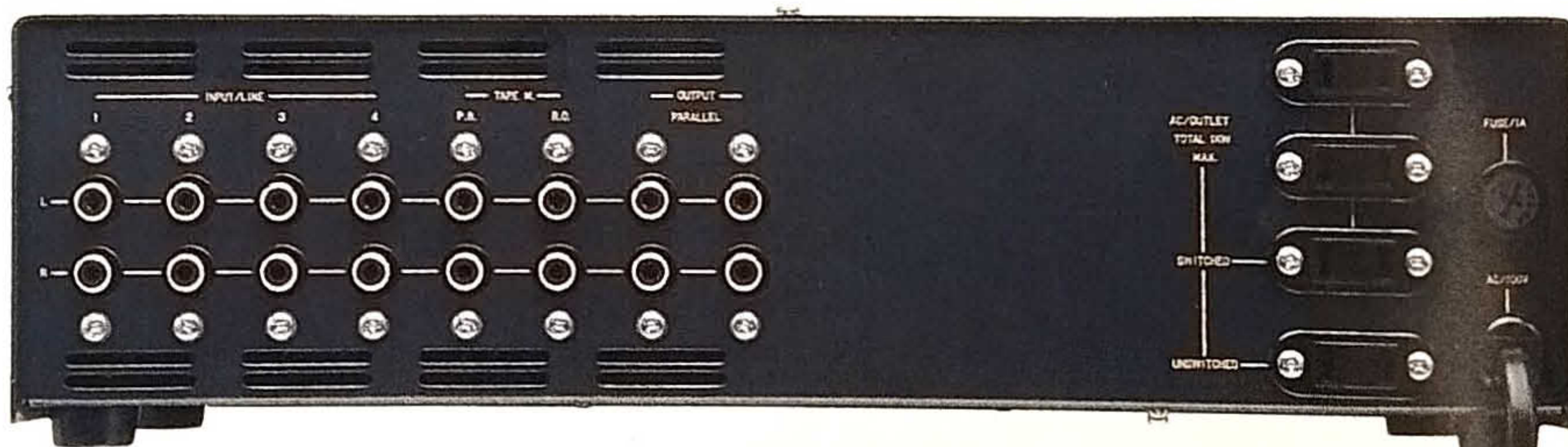
リアパネル。入力端子はLINE4系統。出力はLINE2系統で、パラレルに接続されている。サービスコンセントは4つあり、3つが電源連動、1つが非連動。
